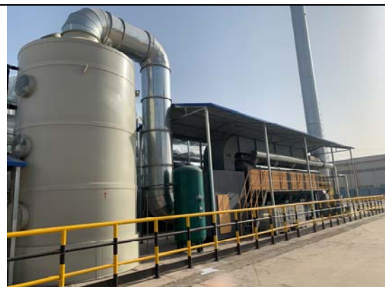
P9 水喷淋+干湿分离过滤器+活性炭吸附脱附+催化燃烧
